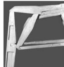
(d) Structure mass 48 gm failed at 492 N
